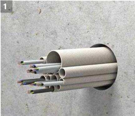
1. Installationsrohre mit oder ohne Kabelbelegung in die Öffnung einlegen. Die Elektroinstallationsrohre müssen mindestens 20 cm über die Wand/Decke hinausragen.
